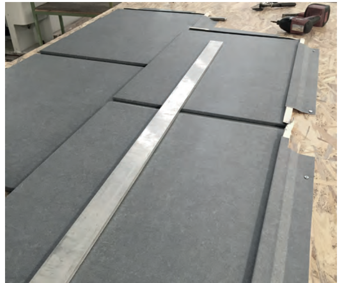
06. Prototipo del modulo di rivestimento metallico realizzato artigianalmente durante la fase di studio del prodotto. Massimiliano Condotta
