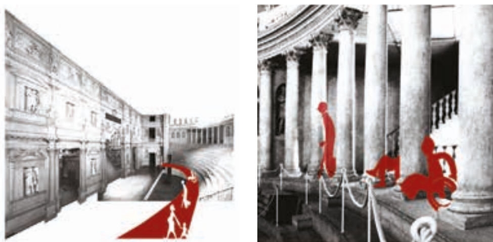
Fig.03 A sinistra il nuovo ballatoio mobile, progetto. Il dispositivo tecnologico è utilizzabile solo in occasione degli spettacoli ed è rivolto a risolvere la questione sulla sicurezza del teatro e a migliorare la logica di collocazione delle persone con disabilità. A destra, loggia accessibile, progetto. L'inserimento di una piattaforma elevatrice in uno dei due vani scala permette a tutti gli utenti di raggiungere la sommità della cavea agevolmente.
