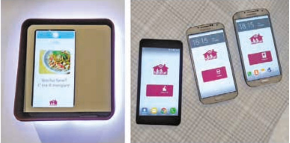
Fig.02 Nelle figure, a sinistra è visibile lo smart object radio finale, rappresentato dalla cornice e dallo schermo touch screen . In quella a destra, invece, sono rappresentate alcune interfacce della app per le differenti utenze o usi: anziano autosufficiente, caregiver o operatore e l'app con i dati di monitoraggio della sedia.
