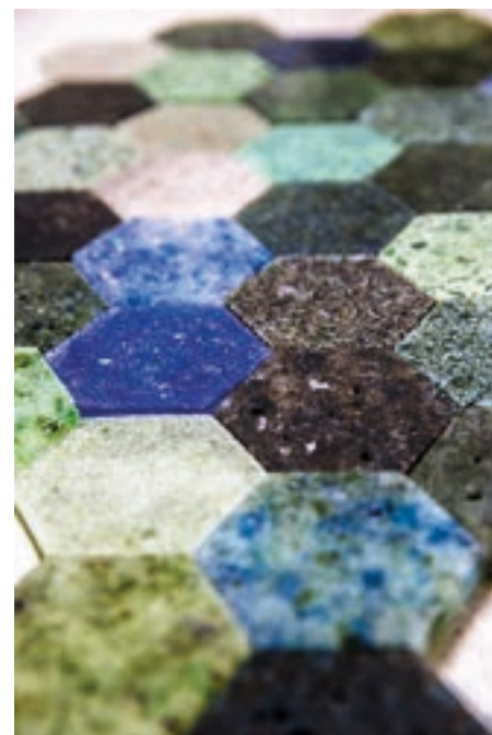
05. Alcuni prodotti realizzati da GlassLab, ottenuti dalla miscela di vetro di scarto frantumato con bio-resina vegetale. Tra i prodotti proposti, una piastrella esagonale, la cui composizione esalta i differenti toni di colore. GlassLab
