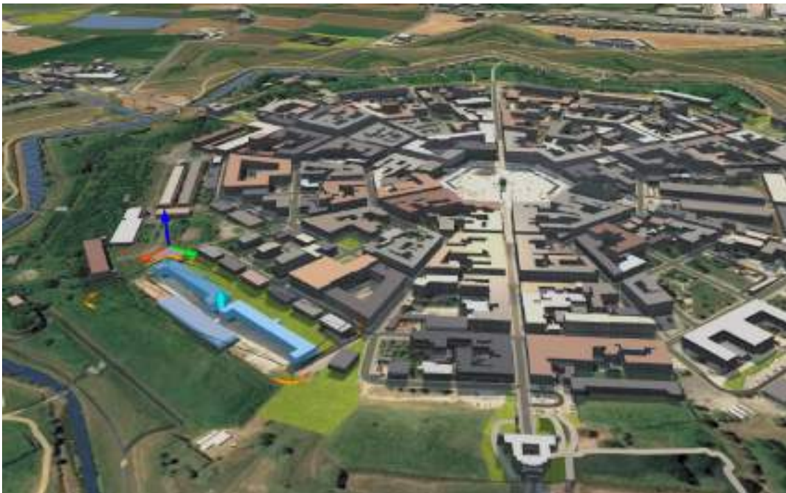
Figura 2. Modellazione e consultazione dei dati attraverso il software Infracore, adatto a visualizzare informazioni territoriali (GIS) oltre a collegare file .ifc (BIM)
