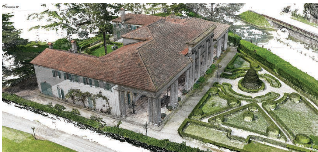
Fig. 2. Nuvola di punti ottenuta dal rilievo fotogrammetrico, Villa Valmarana (elaborazione grafica degli autori).
