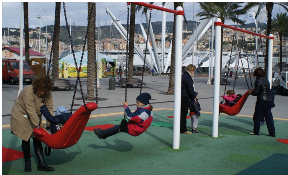
Fig.02 Parco giochi inclusivo di Genova. Altalene con seggiolini in gomma e modelli con spalliera alta e sponde laterali, pensate per garantire stabilità e sicurezza ai bambini con disabilità motorie e sensoriali.
