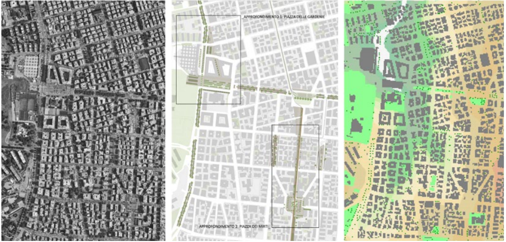
Fig.01 Strategia progettuale complessiva in cui si evidenziano i principali spazi di trasformazione che prevedono modifiche alla mobilità, trasformazioni delle sezioni stradali, introduzione di sistemi vegetali rimozione dell'asfalto e sostituzione con materiali dalle migliori prestazioni climatiche. Foto aerea, planimetria di progetto, base del modello ENVI-met per simulazioni microclimatiche.
