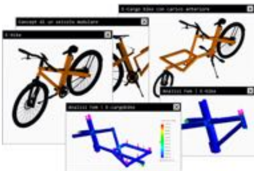
2. Chiara Pacini, Jonathan Lagrimino, Alessandra Rinaldi, Concept di un veicolo leggero modulare configurabile come e-bike e come e-cargo bike con carico anteriore. L'analisi FEM viene applicata per verificare la stabilità del telaio, composto da due moduli separabili all'altezza del piantone , 2024. (© / Courtesy Pacini, Lagrimino, Rinaldi)
