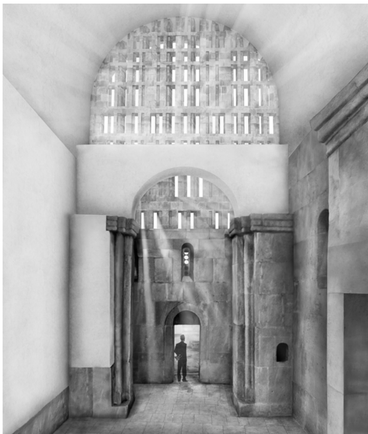
Fig. 1 Monastero di Arates. Progetto della chiesa della Santa Madre di Dio ( Surb Astuatsitsin ). Rendering dell'interno che enfatizza il reticolo di aperture gnomoniche orientate ad est caratterizzanti il prospetto esterno principale. Elaborati tratti dalla tesi dall'autore, con titolo La forma nel Tempo: Arates - Armenia .
