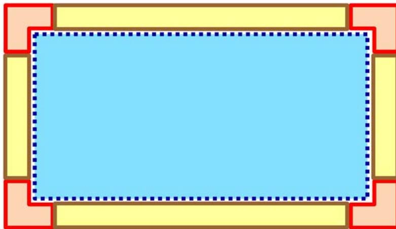
Figura 6 – Esoscheletro con strutture verticali ai vertici (ad "L") e strutture orizzontali controventate ai piani.
