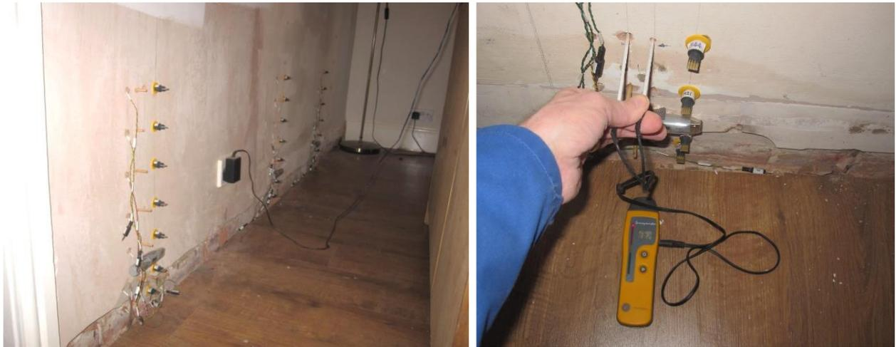
*Apparato di monitoraggio della risalita capillare (sinistra) e sistema resistivo in profondità (destra)*
