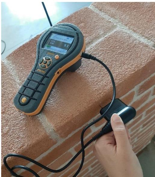
Figura 51. Termoigrometro Protimeter MMS2 e sonda ad aghi.
