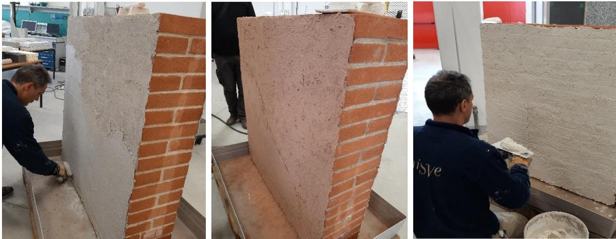
Figura 44. Stesura intonaci sulle murature in laboratorio: da sinistra, intonaco di calce e sabbia, cocciopesto e marmorino.
