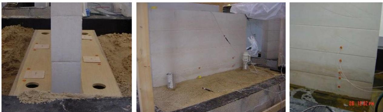
*Modelli di muratura in laboratorio con dispositivo di ventilazione meccanica controllata (sopra) e sonde di monitoraggio (sotto)*
