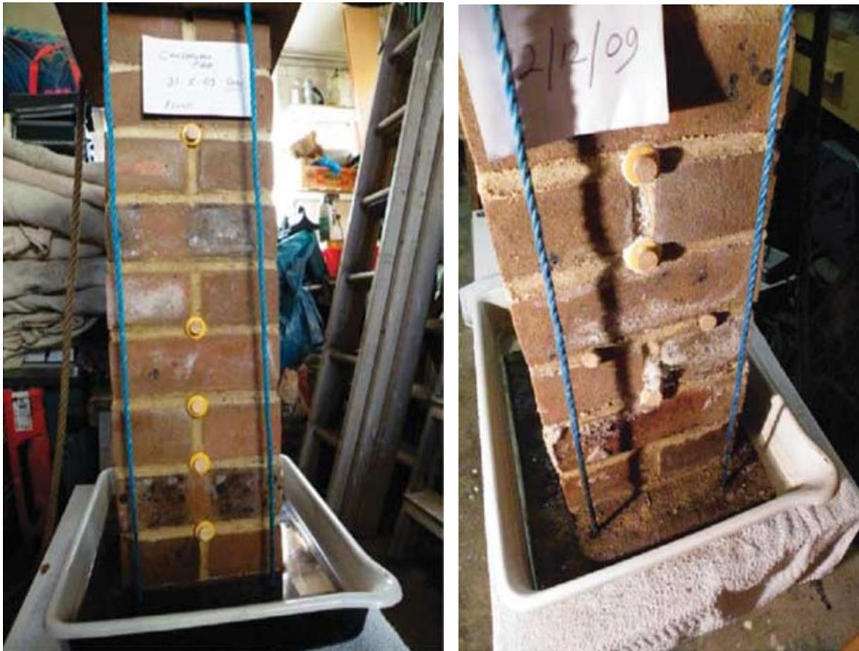
*Modello di pilastro in mattoni in laboratorio (sinistra) e applicazione della barriera chimica (destra)*
