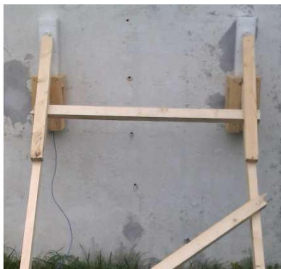
*A destra set-up elettrodi; a sinistra, posizionamento elettrodi sulla muratura, con supporto in legno per rivestimento con film plastico*
