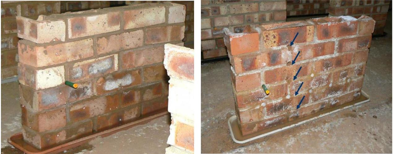
*Modello di muratura in laboratorio con posizionamento sonde di monitoraggio*
