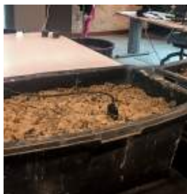
Mesocosmo 2. Acqua dolce, pioggia leggera 10 mm; volume terra 43 litri. Obiettivo: verificare come varia il tenore salino irrigando con acqua dolce per capire il potere abbattente dell'acqua dolce sulla salinità.
