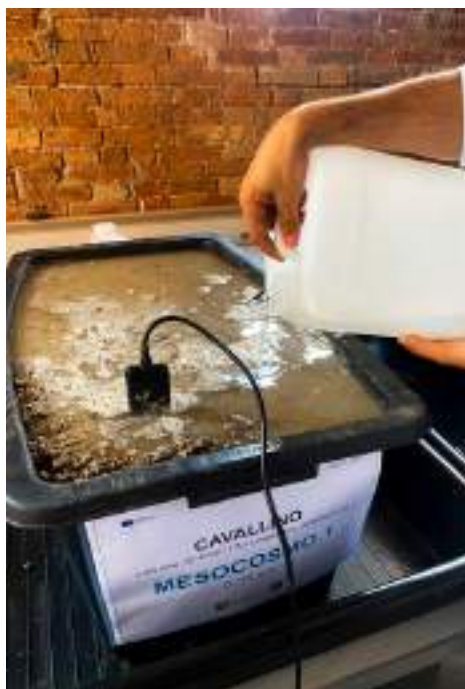
Mesocosmo 1. Acqua marina, allagamento estremo 10 cm d'acqua; volume terra 56 litri; senza drenaggio. Obiettivo: Simulare un evento "estremo" di mareggiata e monitorare le conseguenze in termini di conducibilità nel terreno.
