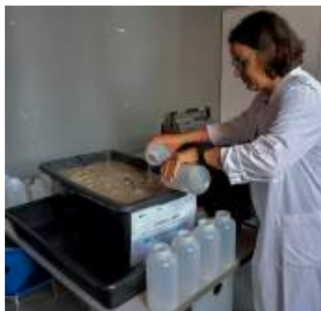
Mesocosmo 3. Acqua salmastra, allagamento leggero 5 cm d'acqua; volume terra 49 litri. Obiettivo: verificare con terreno attuale come varia il tenore salino irrigando/allagando con acqua salmastra.
