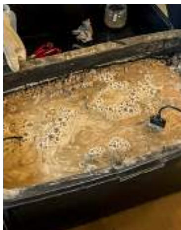
Mesocosmo 6. Acqua marina, allagamento estremo 10 cm d'acqua; volume terra 56 litri; con drenaggio. Obiettivo: capire come dopo lo stesso evento estremo, intervenendo con drenaggi/pompe che tolgono acqua, cambiano le conseguenze nel terreno.
