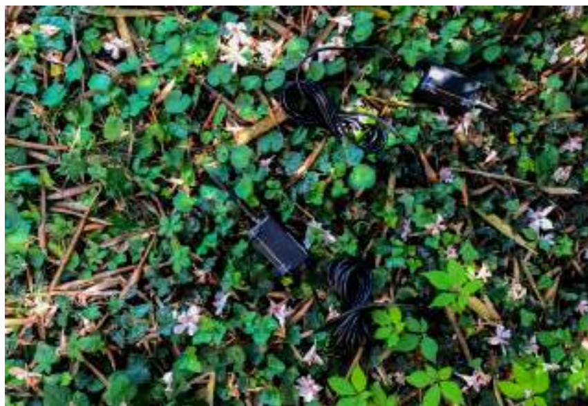
Prove di calibrazione dei sensori e verifica della ricezione del segnale dell'antenna LoRaWAN su terreno di test presso Thetis S.p.A..
