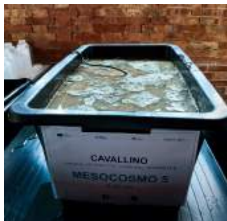
Mesocosmo 5. Acqua salmastra, allagamento moderato 10 cm d'acqua; volume terra 47 litri. Obiettivo: verificare con terreno attuale come varia il tenore salino irrigando/allagando con acqua salmastra.
