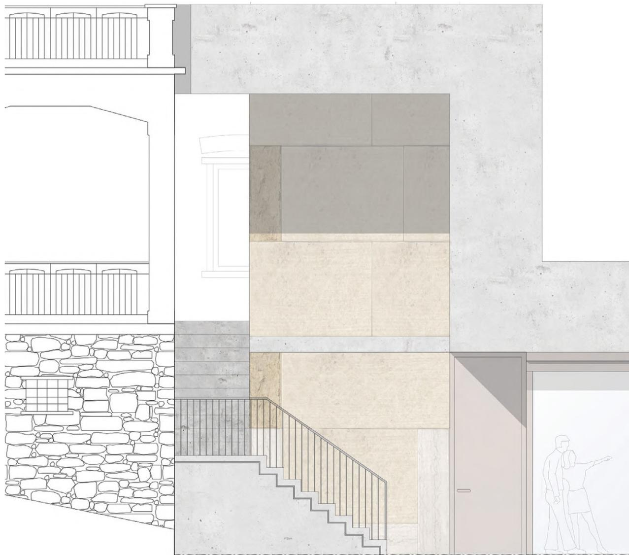
Prospetto con dettaglio dei materiali, sezione tecnologica, esploso della Bottega Alla Terrazza degli studenti Baggio, Ongarato, Faivre, Collado.
