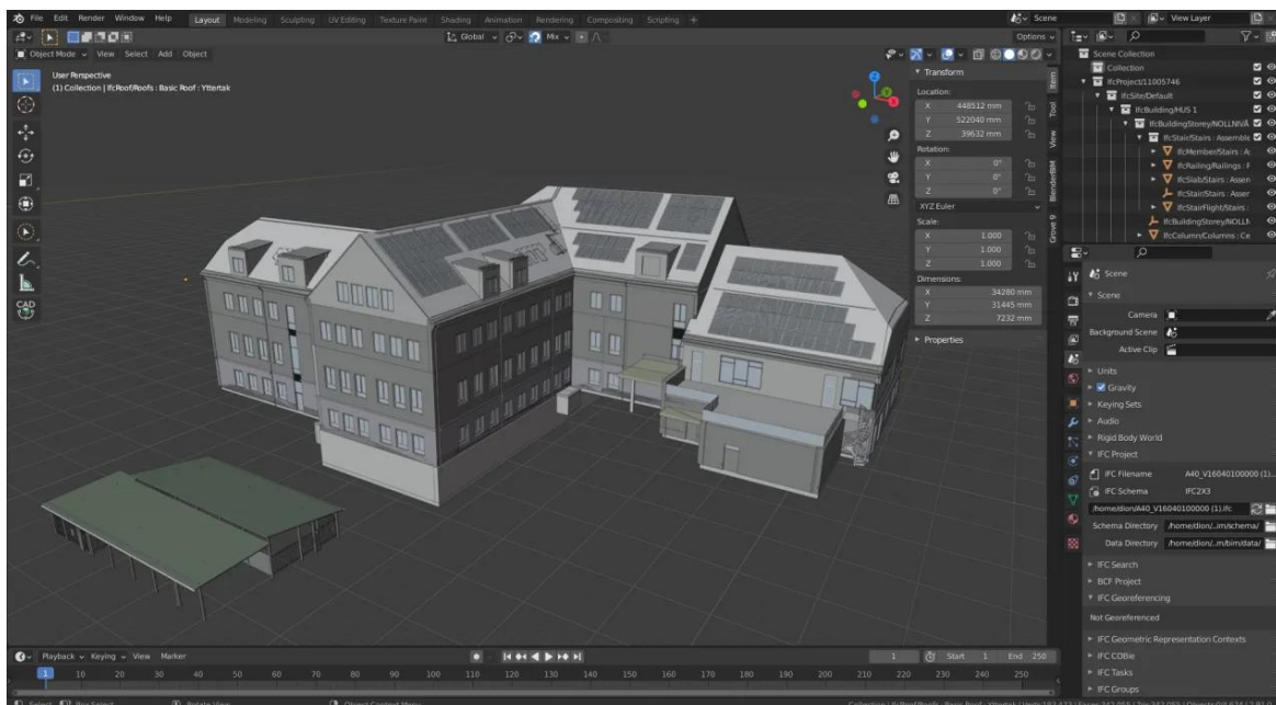
Fig. 1.43: Visualizzazione di un modello IFC in Blender-Bonsai (fonte: Blender Extensions)
