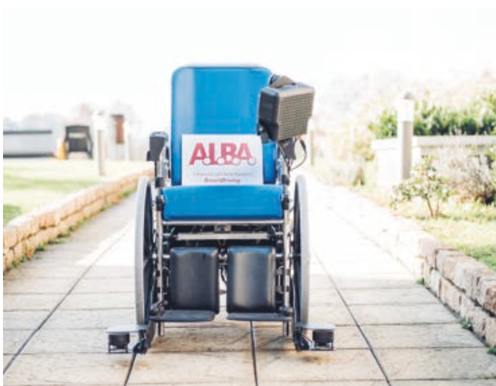
Fig.03 La sedia a rotelle a guida autonoma è sempre connessa tramite l'Internet of Things.
