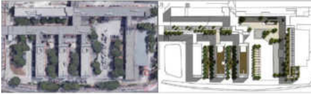
Fig. 4| Progetto di riqualificazione degli edifici a pettine. A sinistra lo stato di fatto, fonte Google maps; a destra le superfici idonee alla trasformazione in favore di rain arden e tetti verdi, fonte: elaborazione degli autori.
