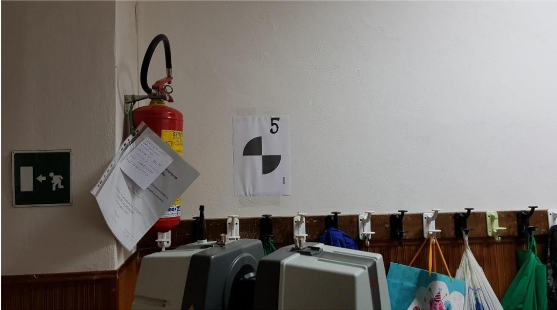
*Figura 63 - Target numerico per il rilievo laser scanner*
