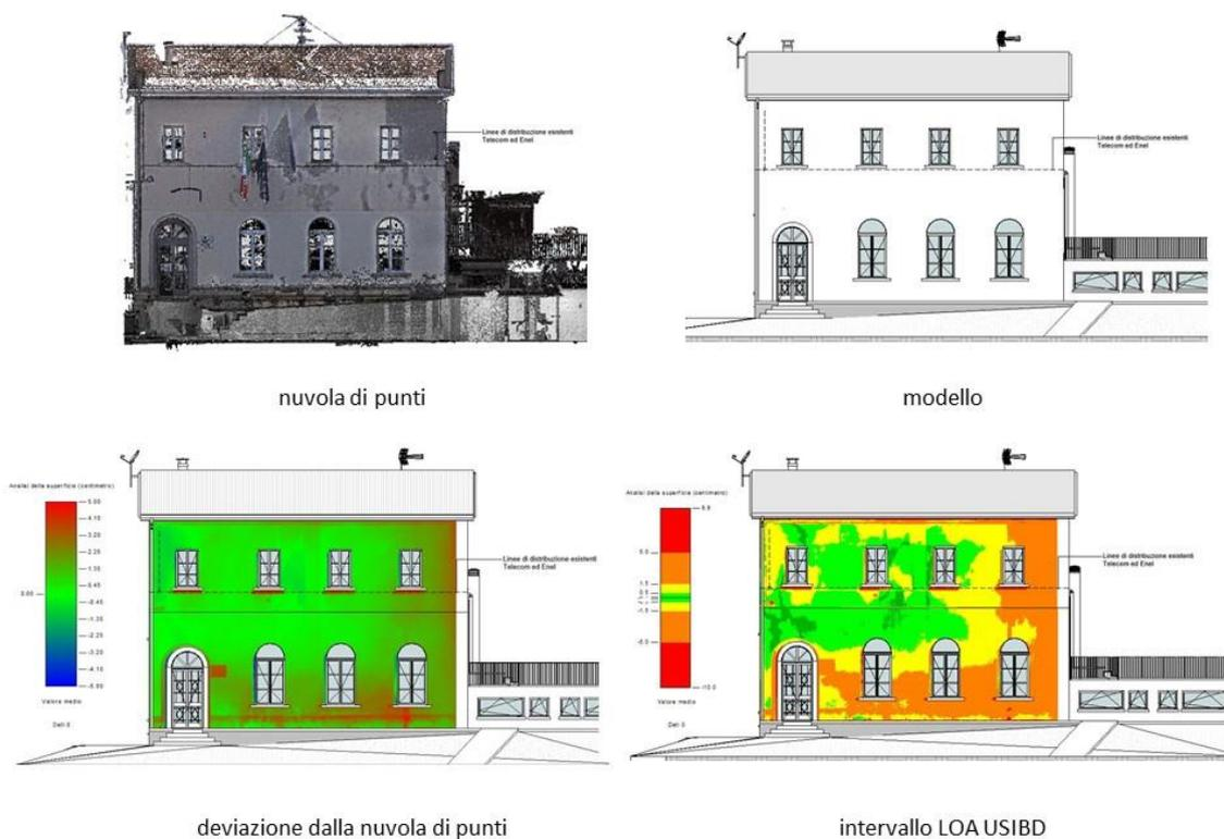
*Figura 68 - Risultati analisi As-Built Prospetto Nord*
