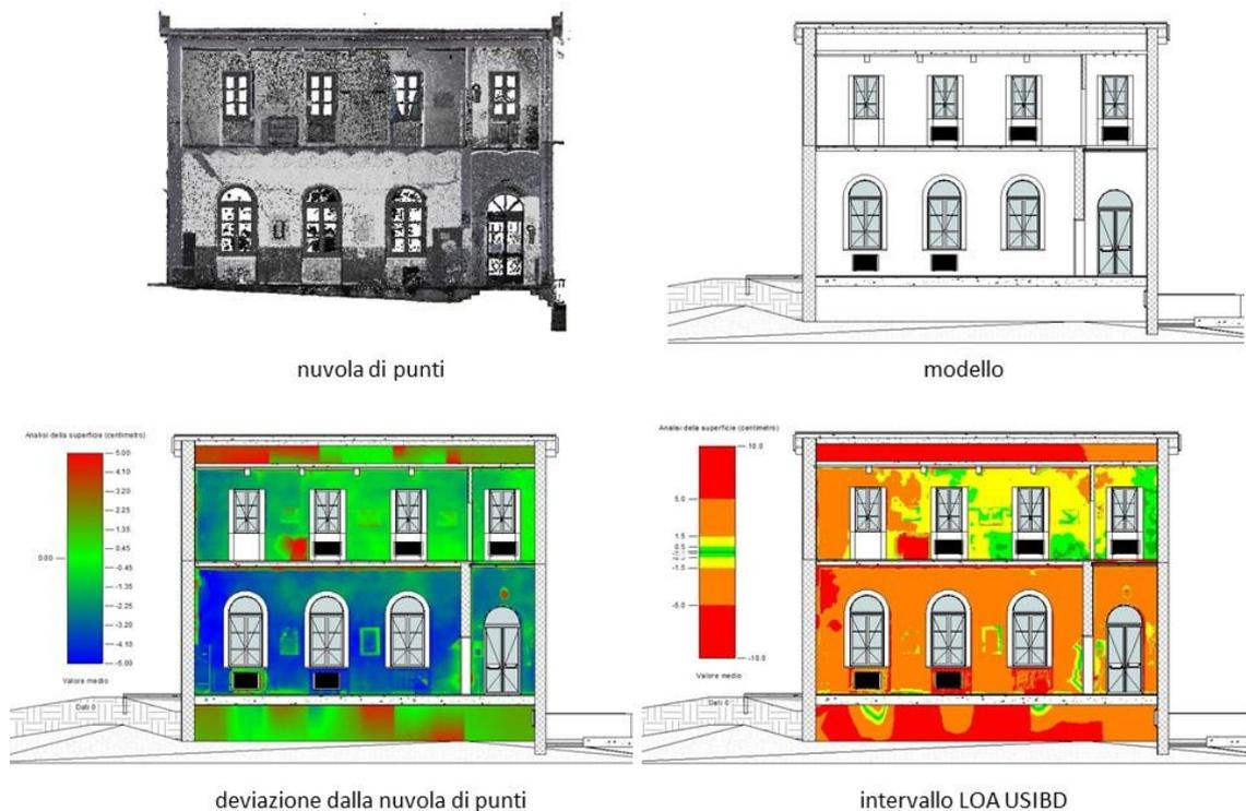
*Figura 69 - Risultati analisi As-Built Sezione AA*
