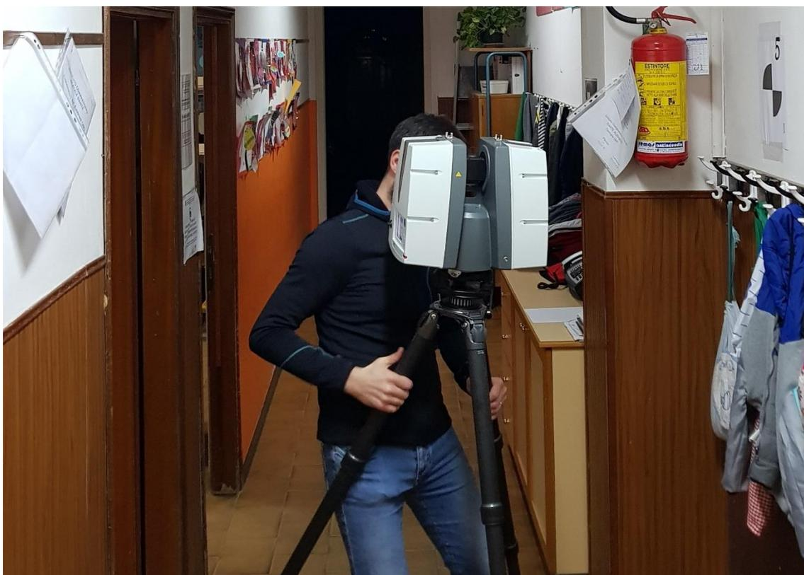
*Figura 59 - Fasi di rilievo con laser scanner Leica P40*
