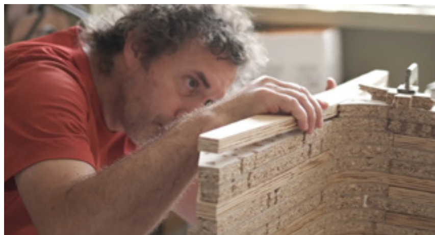
2. Scatto del montaggio di una seduta. L'estetica dello scarto, dove sfridi lignei di diversa natura - dal multistrato al truciolare - generano un'progressione visiva di sfumature cromatiche
