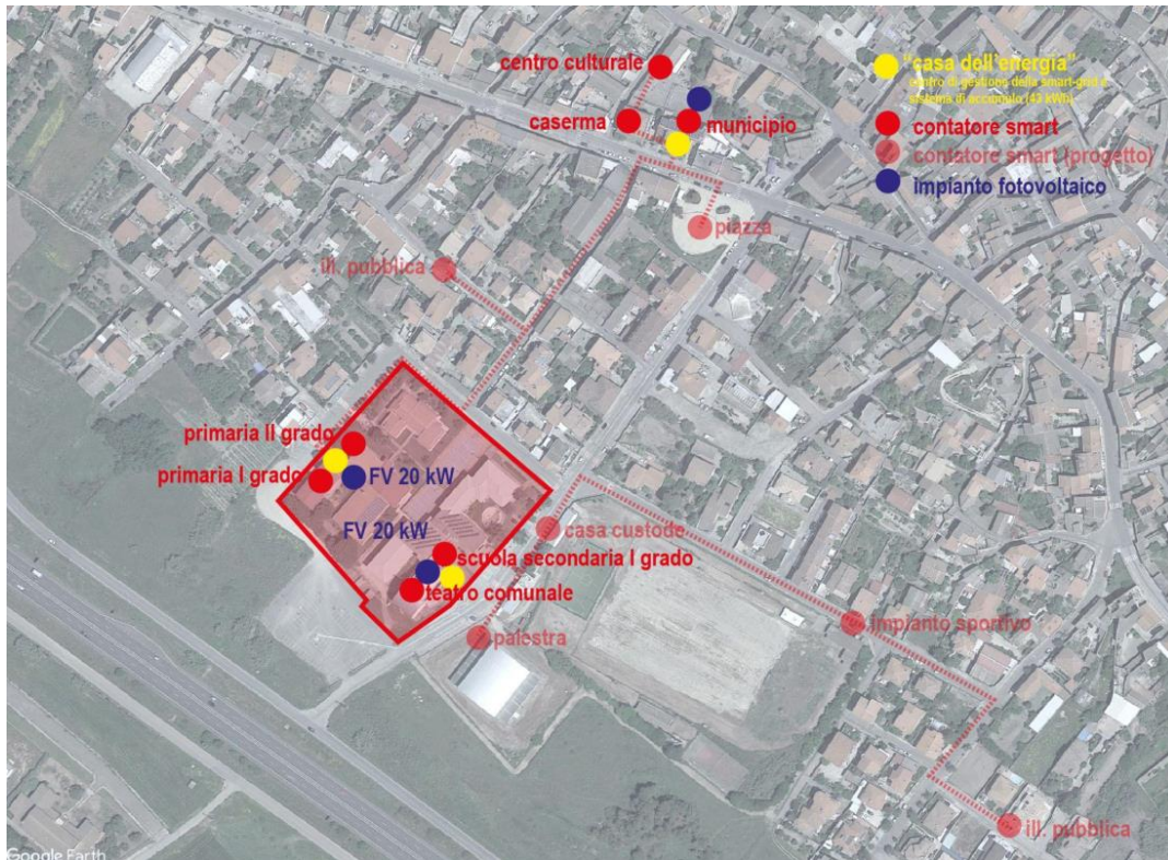
Figura 1 | La smart grid di Serrenti. L'installazione dei pannelli fotovoltaici sulle coperture del plesso scolastico hanno permesso la creazione di due micro smart-grid. L'energia prodotta in surplus durante le ore extra-scolastiche viene immagazzinata in sistemi di accumulo (case dell'energia) e ridistribuita ad altri edifici pubblici.
