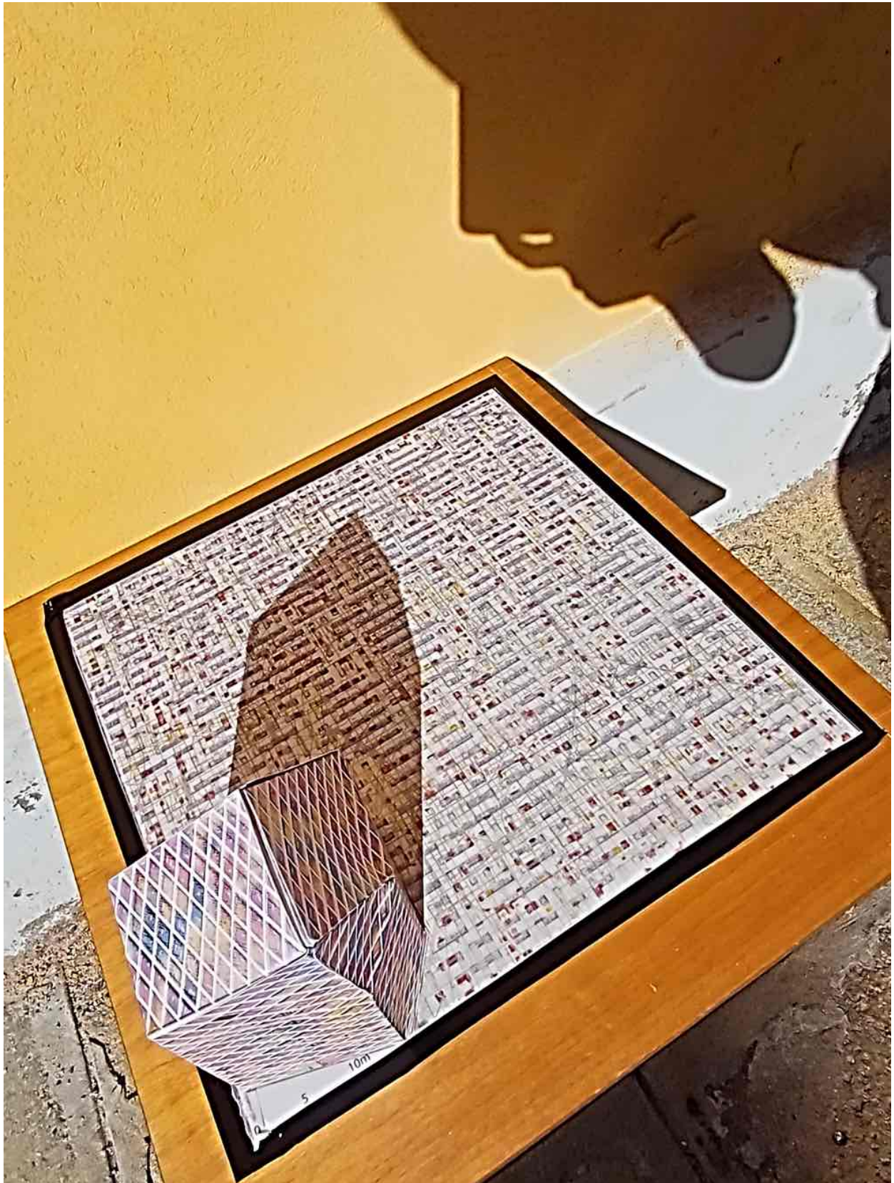
Figura 35 - Esempio di fotografia della base del modello completo scattata a quadro inclinato, in modo che le tre principali direzioni tri-ortogonali (X, Y, Z) del modello obiettivo abbiano un punto di fuga proprio rintracciabile sul piano dell'immagine.
