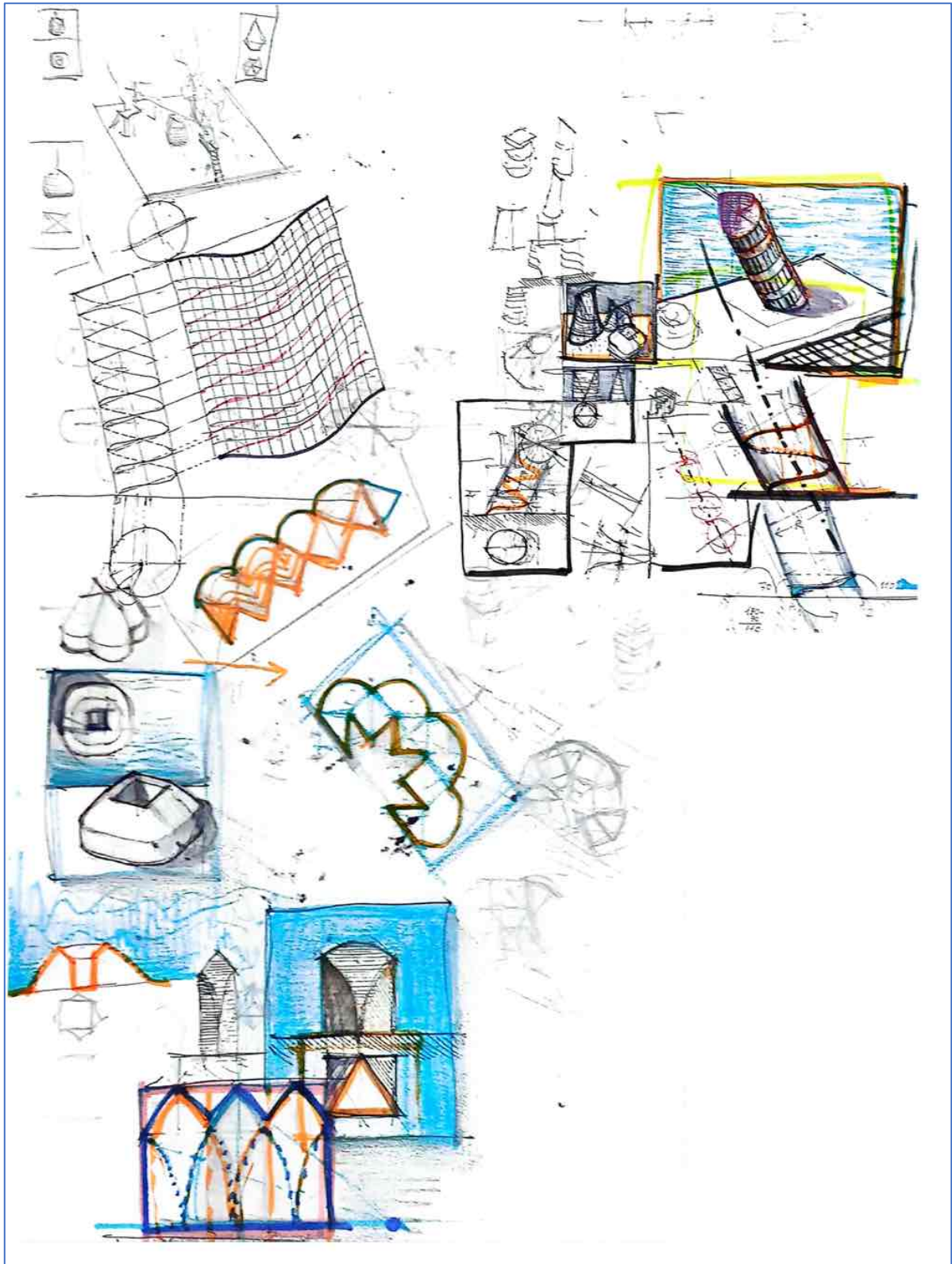
Figura 28 - schizzi e disegni di ideazione di corpi componenti la composizione del "Campo dei Miracoli" a Tokyo. In alto studi sulla versione della "Torre pendente" resa con un cilindro ellittico ad asse inclinato e percorso da una rampa elicoidale a pendenza costante. A sinistra è tracciato lo sviluppo piano della torre. In basso, studio di quattro corpi: un corpo ad impluvio centrale, un corpo coperto a falde e coni su pianta a croce greca, un corpo su pianta triangolare equilatera la cui superficie è a padiglione ma a segmenti inversamente simmetrici lungo le piegature della superficie indicata in basso nel suo completo sviluppo piano dove sono indicate le piegature.
