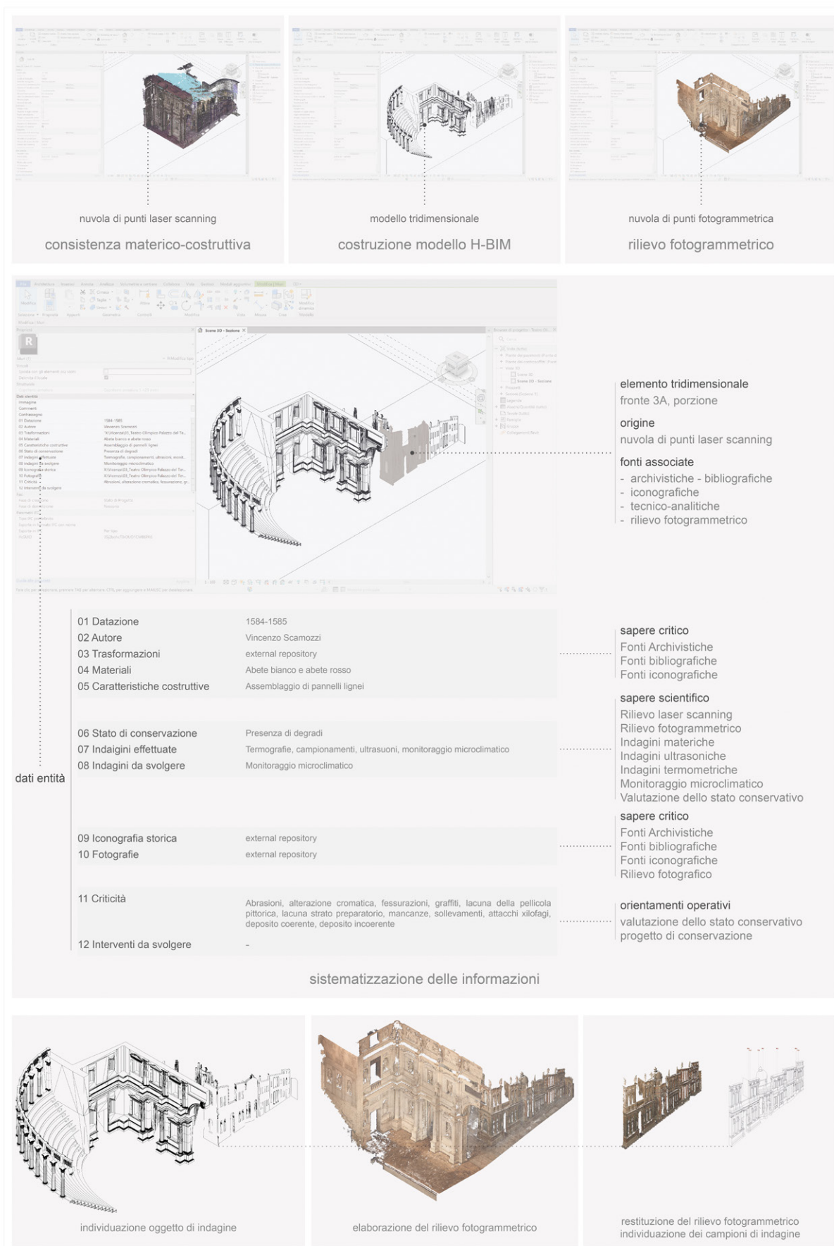
Fig. 2. L'elaborato grafico rappresenta il processo di acquisizione del dato geometrico, modellazione del Teatro Olimpico all'interno dell'ambiente HBIM e successivo collegamento del rilievo fotogrammetrico. Al centro viene descritto il procedimento di gestione delle informazioni nel modello HBIM. Infine, viene descritta la scelta della porzione oggetto di specifica indagine (proscenio e scene scamozziane), relativo rilievo fotogrammetrico, elaborazione delle ortofoto e successivo collegamento con le analisi svolte sul bene. (Elab. M. Tosato 2023).
