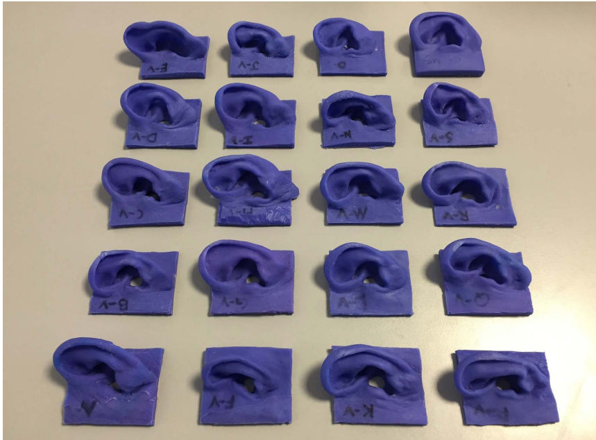
Fig. 3. I 20 campioni di orecchio artificiale utilizzati per le misurazioni di HRTF. Foto di Simone Spagnol rilasciata sotto licenza CC-BY-4.0. University of Iceland, 2019.
