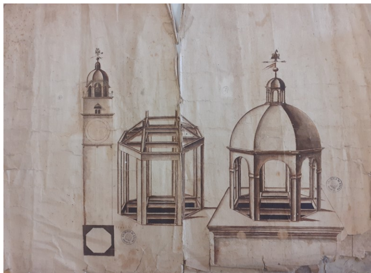
4. F. Pacchioni (attr.), disegni per il restauro della cella campanaria della torre del palazzo del Monte a Reggio Emilia, 1625-1626, ASRe, Carte private diverse, 66-68bis
