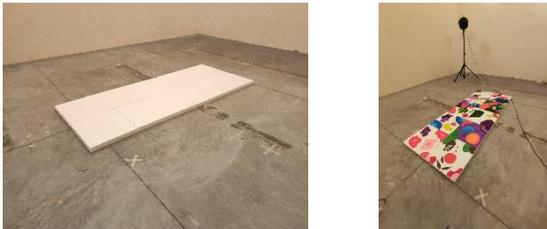
Figura 4 - Condizione di allestimento della camera riverberante per la valutazione dell'area di assorbimento unitaria per pannelli disposti in continuo.
