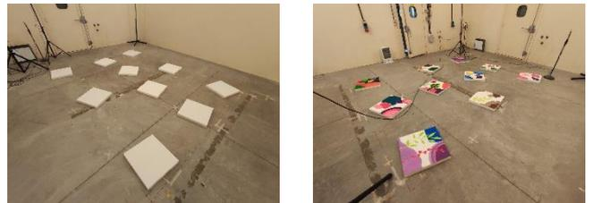
Figura 8 - Condizione di allestimento della camera riverberante per la valutazione dell'area di assorbimento unitaria per pannelli disposti come oggetti discreti.
