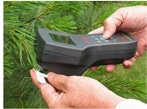
Figura 44: Fluorometro portatile per la misurazione sul campo dello stress delle piante (fonte: Opti-Sciences Inc.)
