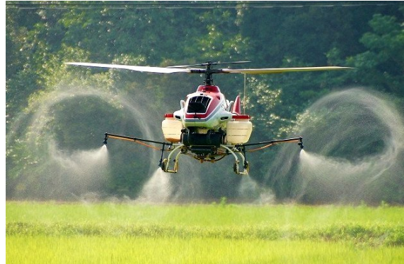
Figura 74: il Yamaha RMAX è stato uno dei primi elicotteri pilotati ad essere stato realizzato per l'agricoltura di precisione (fonte: Yamaha Motor Corp.)
