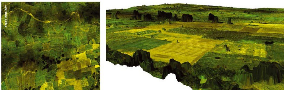
Figura 71: rappresentazione reale (a sinistra) e visualizzazione del rispettivo modello 3D (a destra) di un territorio agricolo prodotta da un'immagine acquisita da una piattaforma UAV (fonte: STARS Project)
