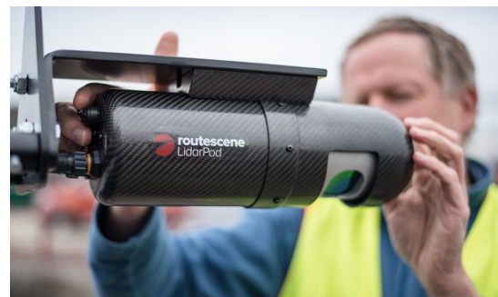
Figura 77: un sensore LIDAR progettato per essere utilizzato dagli UAV (fonte: Mapix Technologies)
