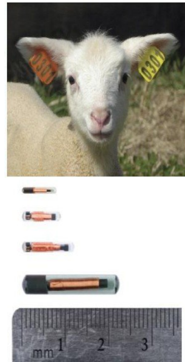
Figura 55: esempi di RFID applicati sulle orecchie di un animale da pascolo e per utilizzo sottocutaneo (fonte: Premier Supplies, Biomark Inc.)
