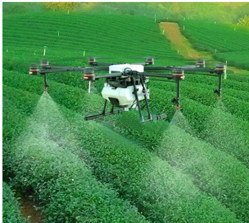
Figura 75: il drone DJI Agras MG-1 come soluzione commerciale per lo spraying sulle colture (fonte: DJI Ltd.)
