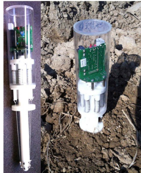
Figura 87: prototipo di Fertimetro dotata di elettronica di controllo capace di memorizzare i dati e in grado di utilizzare ulteriori sensori di temperatura e umidità (fonte: Concheri G. et al., 2017, op. cit.)
