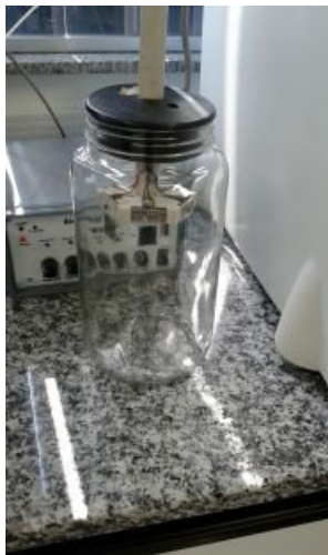
Figura 106: prototipo di naso artificiale o olfattimetro (fonte: Autore)
