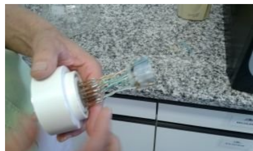
Figura 107: prototipo di lingua artificiale o saporimetro (fonte: Autore)
