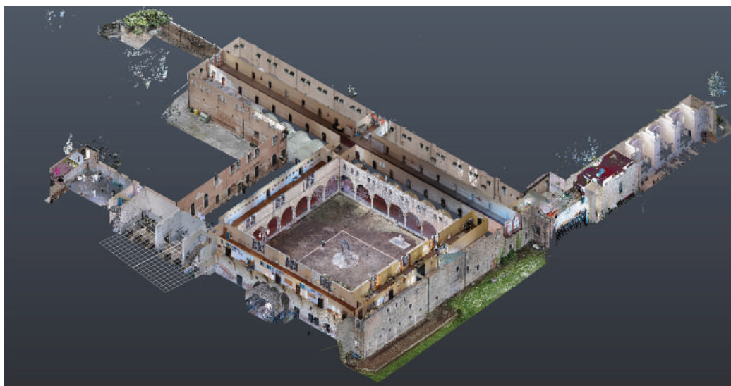
Fig. 7. Nuvola di punti totale risultante dal rilievo integrato in assonometria sezionata (elaborazione a cura degli autori).
