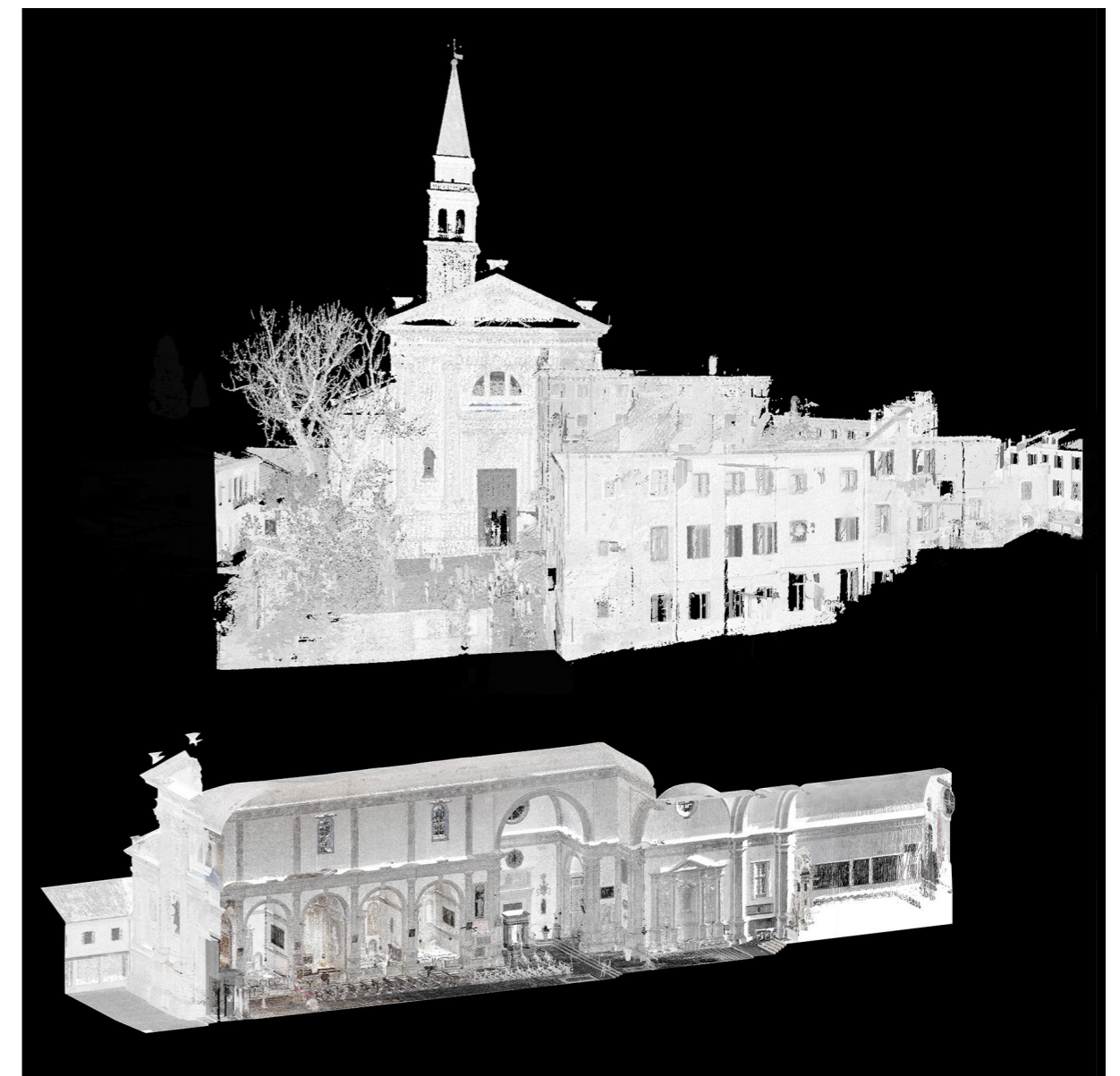
Fig. 1 - Rilievo laser scanner. Elaborazioni digitali di M. Bertolini in collaborazione con il Laboratorio VIDE, Università Iuav di Venezia.
