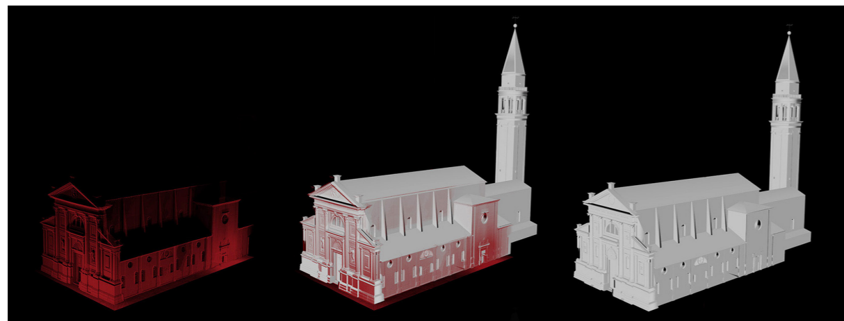
Fig. 2 - Modello virtuale ottenuto dalla nuvola di punti. Elaborazione digitale di M. Bertolini.
