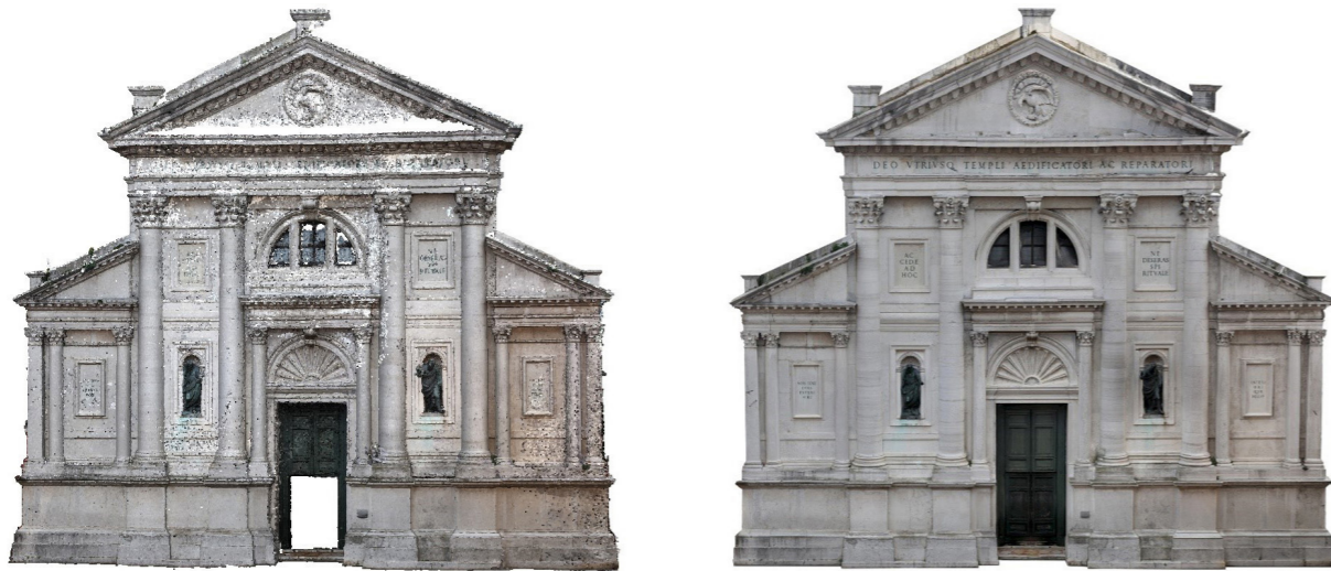
Fig. 7 - Nuvola di punti da rilievo indiretto e modello texturizzato della facciata della chiesa. Elaborazioni digitali a cura dello Studio Forti in collaborazione con il Laboratorio VIDE, Università Iuav di Venezia.
