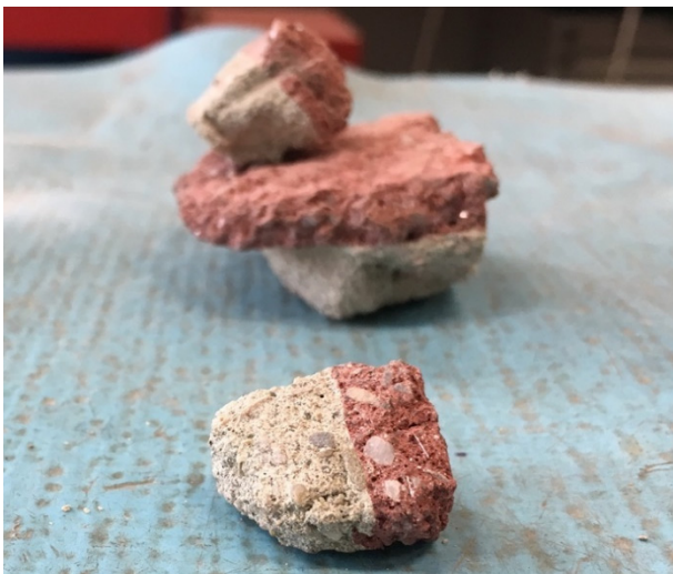
Fig. 2 Sample GIL_I taken from ex G.I.L. (Gioventù Italiana del Littorio) building in Forlì.
