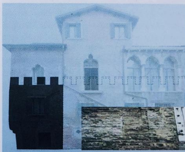
Fig. 5- Venezia: resti di merli di una cinta muraria inglobati in un edificio gotico successivo (ricostruzione, studenti: Gianicola, Omelchenko & Zattarin, luav, a.a. 2014-15)
