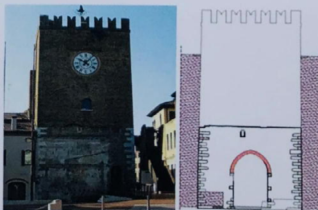
Fig. 11a-b- Torre civica di Mestre: vista e schema ricostruttivo della cinta muraria
