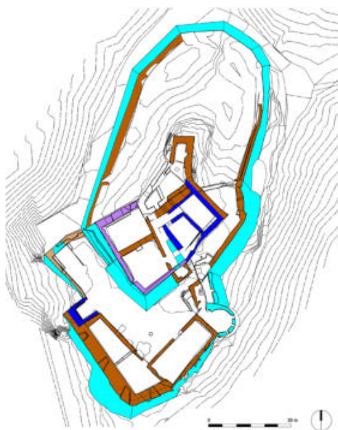
Fig. 2- Planimetria dei periodi costruttivi. Blu: XII secolo; Viola: XIII secolo; Marrone: XIV secolo; Ciano: XV-XVI secolo (Gentilini, Miotello & Zamboni 2013, rielaborato)
