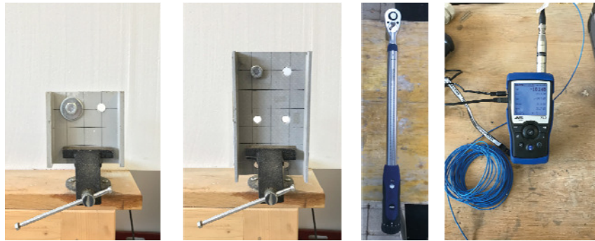
Fig. 36 Profilo A e B. Chiave dinamometrica a serraggio controllato e analizzatore acustico.
