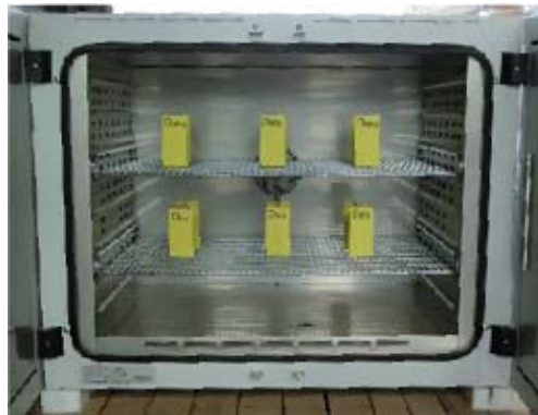
Fig. 28 Provini sottoposti alle prove ad alta temperatura.
