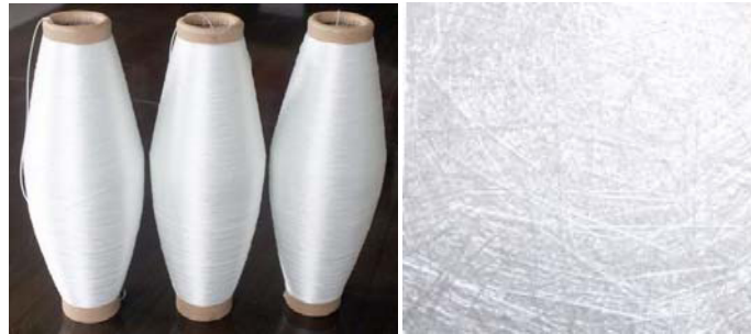
Fig. 7 Sulla sinistra Yarn in fibra di vetro. Sulla destra MAT in fibra di vetro.
