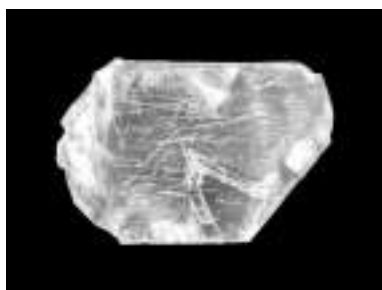
8 | Fragment of lapis specularis (courtesy of the Laboratorio di Analisi di Materiali Antichi LAMA, Università Luav di Venezia).
