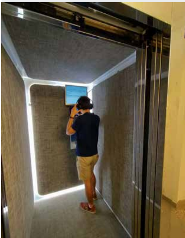
fig. 05: la cabina è corredata di attrezzature audio/video atte alla registrazione dei comportamenti dell'utente e a stabilire comunicazioni durante lo svolgimento del test
