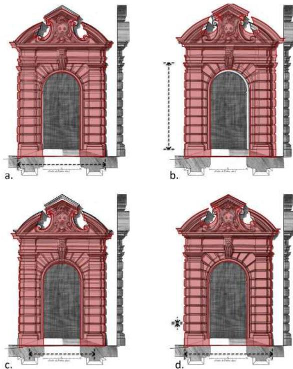
Fig. 7. Verifica dimensionale e proporzionale tra il rilievo attuale (in rosso) e quello dello Specchi (in nero) tramite sovrapposizione secondo diversi sistemi di riferimento: a) larghezza totale fissa; b) altezza delle lesene fissa; c) interasse tra le lesene fissa; d) larghezza totale fissa e modifica dello spessore dei giunti tra le bugne della lesena. Elaborazione grafica di Stefano Costantini.
