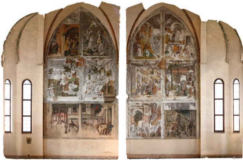
Figg. 9, 10. Ortofoto parete nord e parete sud della Cappella Ovetari a Padova ottenute mediante fotogrammetria digitale.
