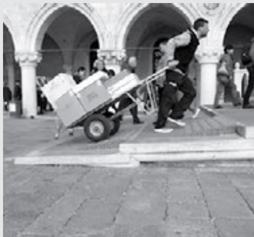
_Superamento di un ponte dotato di rampette. La presenza di rampette amovibili rende il ponte facilmente superabile sia da persone in carrozzina che dai carretti dei trasportatori e dai trolley dei turisti.
