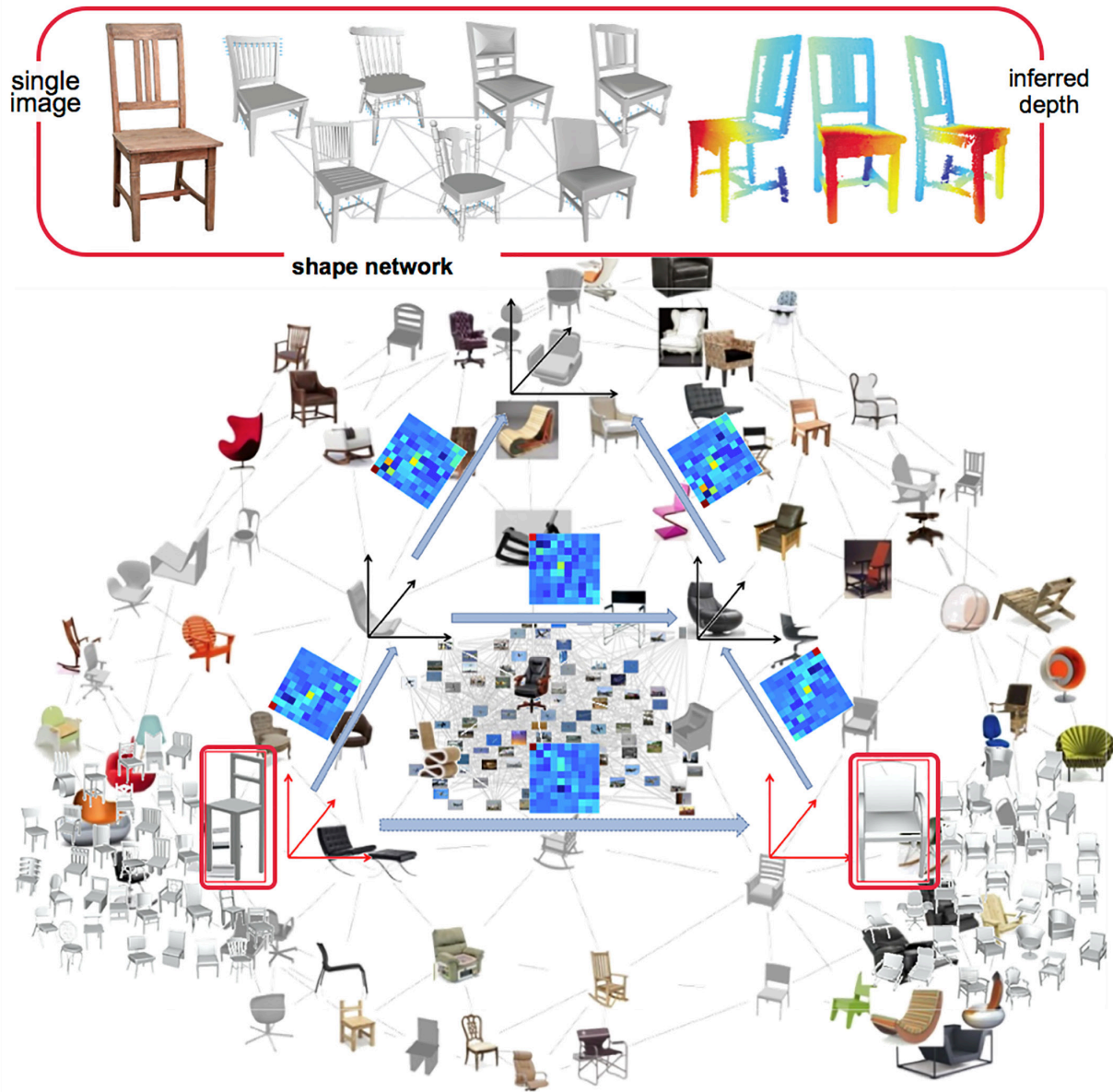
Fig. 9. Riconoscimento e categorizzazione automatica di un oggetto attraverso inferenza di profondità di una singola immagine ed estrazione di caratteristiche da repertori di immagini [Yi et al. 2017].
