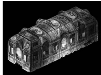
Fig. 8. Esempio di particolare a tutto tondo rivelato dal cono d'ombra generato dalla scansione 3D.
