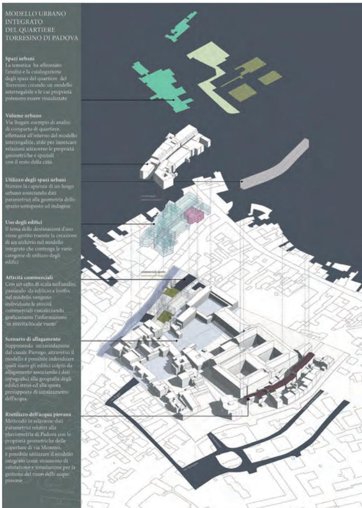
Fig. 03. Modello BIM del quartiere Torresino a Padova: sintesi grafica delle diverse tematiche analizzate e rappresentate nel modello BIM, elaborazione digitale di P. De Cesero
