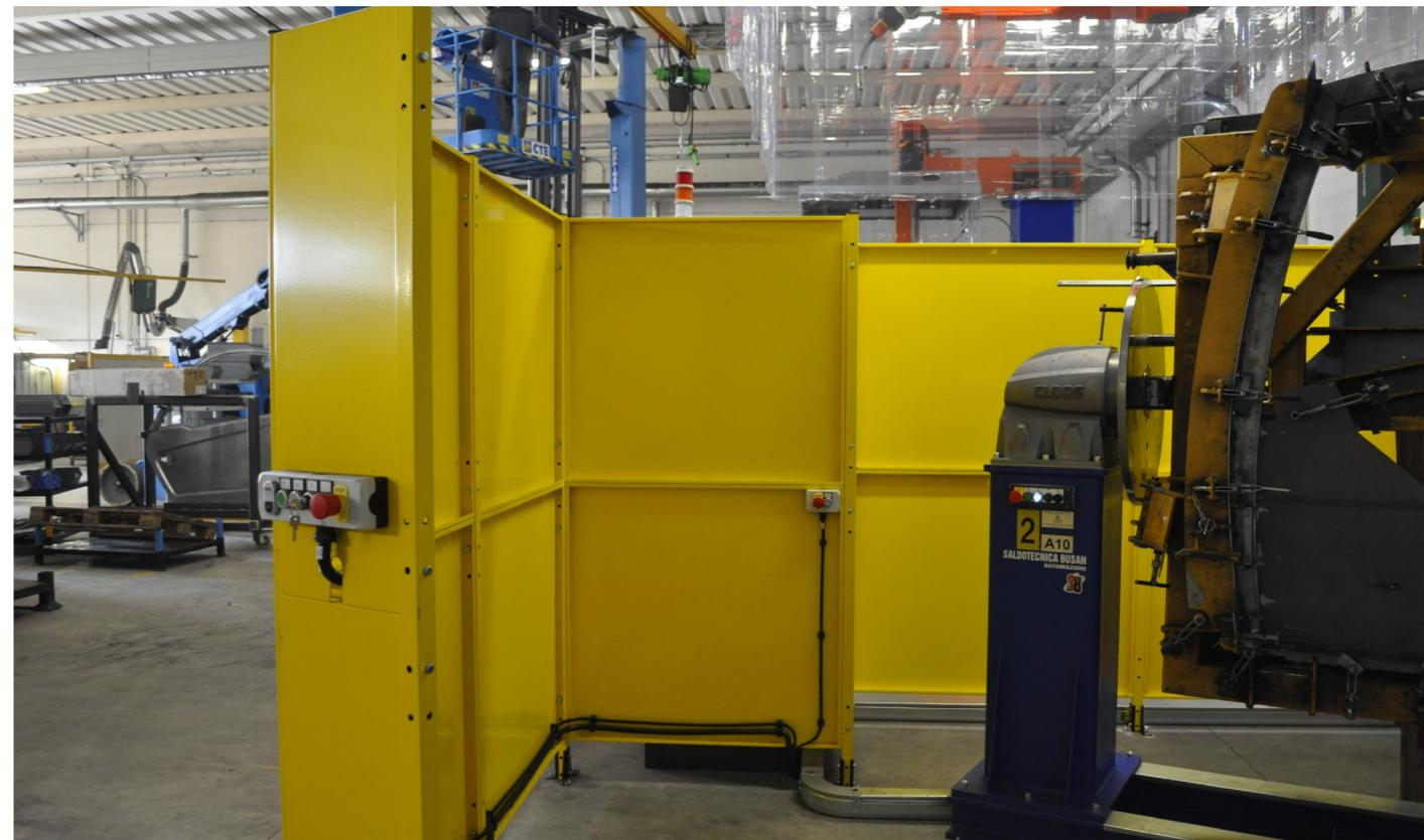
Fig. 3. Barriere di protezione robot, Enrica Cunico, 2019. Barriere di colore giallo per delimitare l'area di lavoro del robot Italcab S.p.A.
