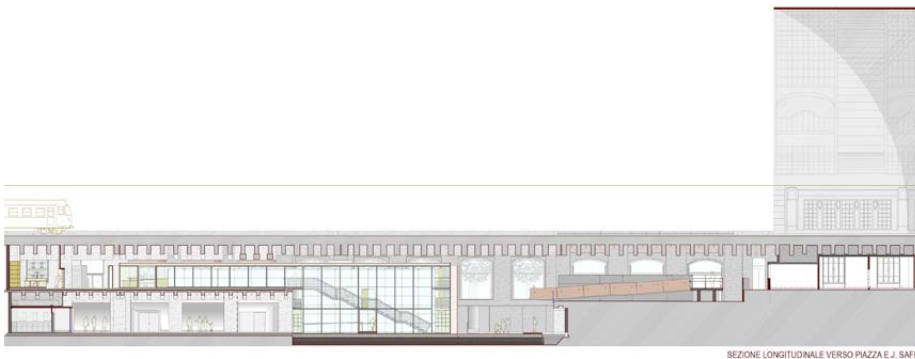
Figura 11. Sezione longitudinale sulla prima campata (prospetto ovest della biblioteca), verso piazza E.J. Safra. (© Morpurgo de Curtis ArchitettiAssociati).
