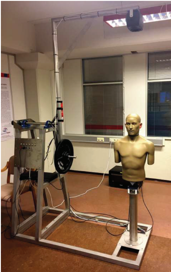
Figura 1. Il sistema di misurazione di HRTF utilizzato.
