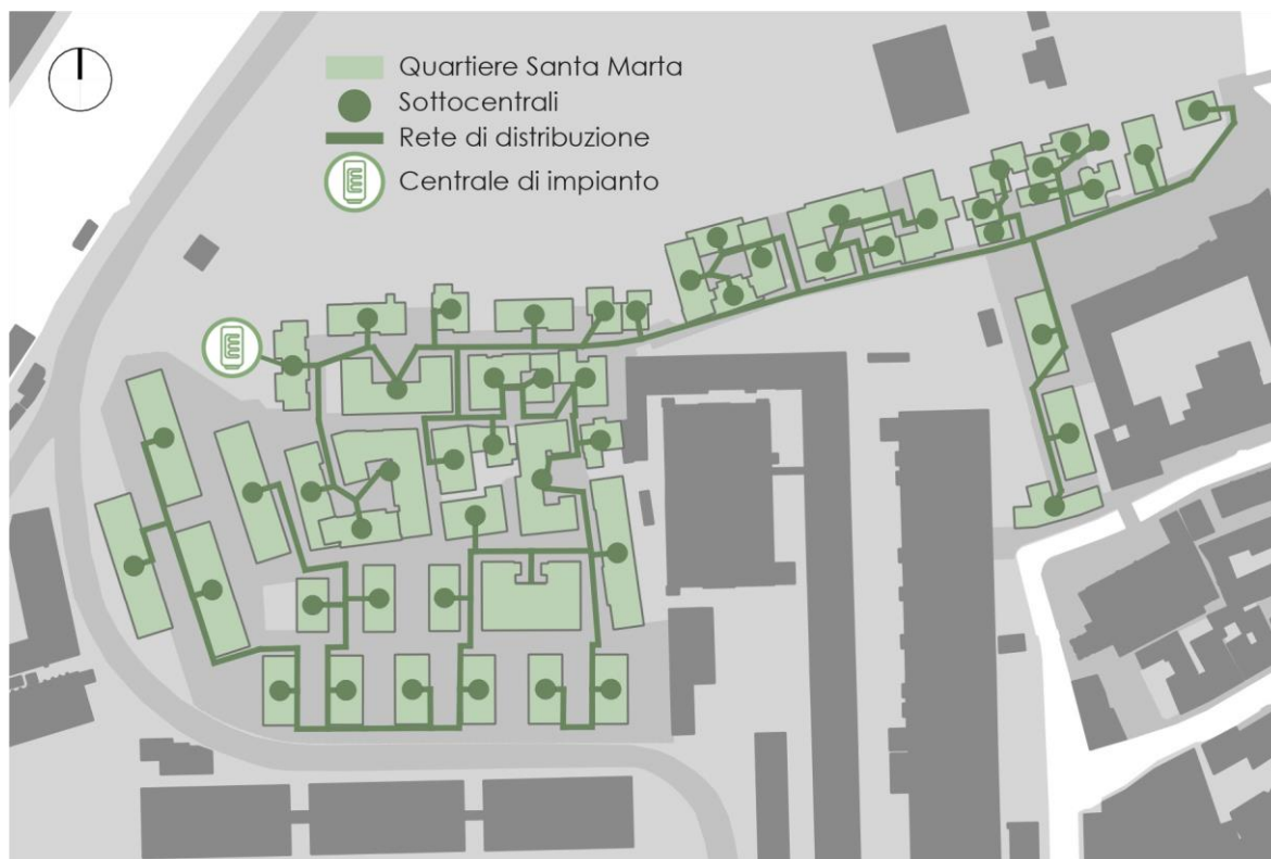
Figura 50 – Planimetria con la rete di distribuzione per impianto centralizzato, elaborazione CEA.
