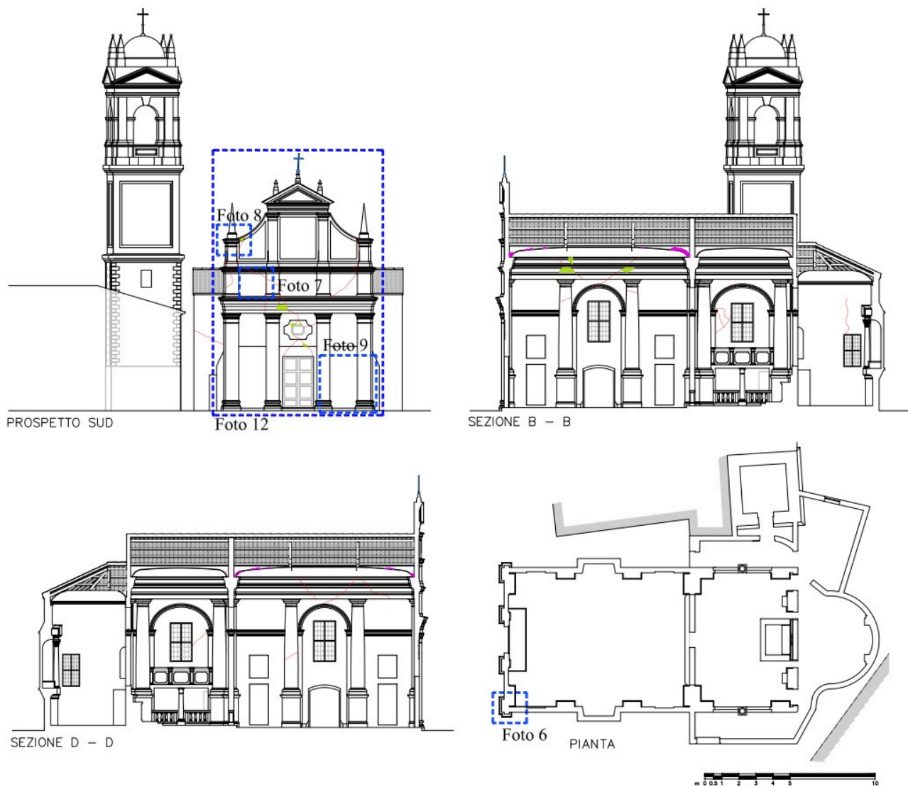
Figura n° 4 Rilievo geometrico e dei danni post sisma. Punti di ripresa fotografici con riferimento alle figure successive
