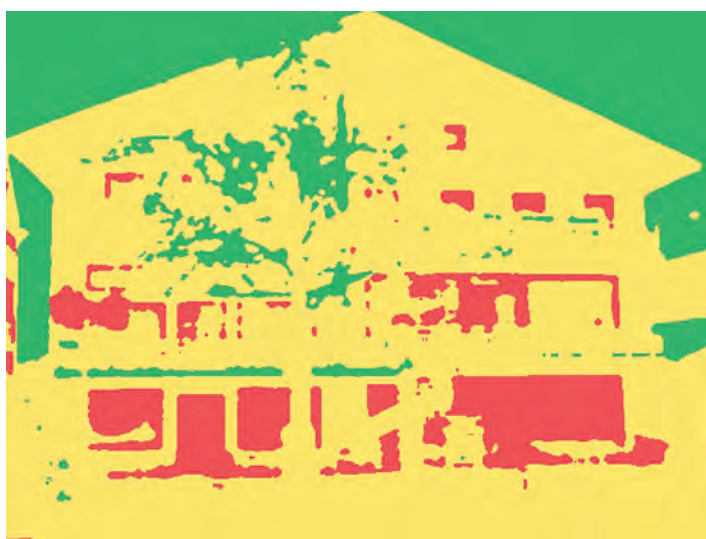
Fig. 3 - Suddivisione delle classi termiche in una facciata.
