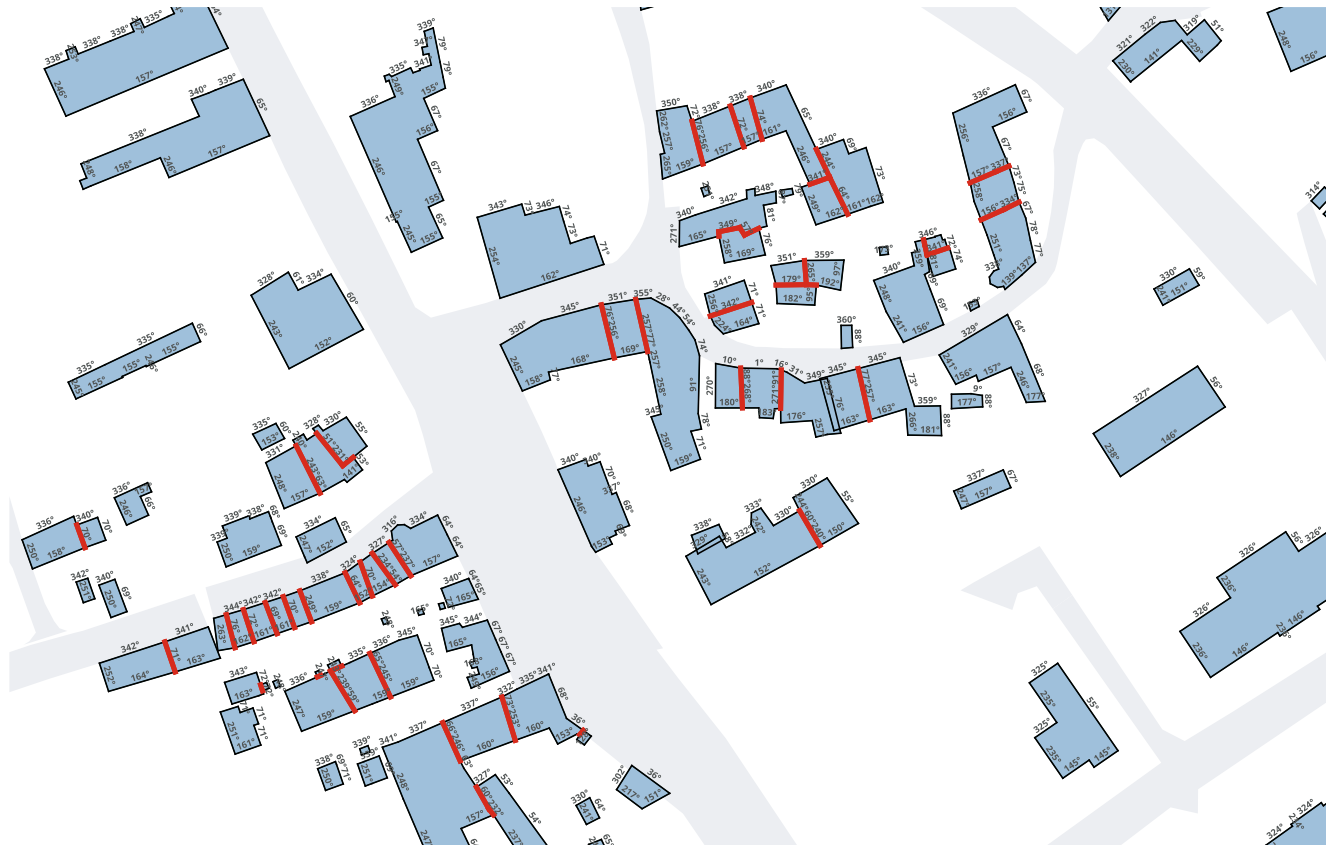
Fig. 3.4. La mappa mostra le inclinazioni delle facciate in gradi sessagesimali. In rosso sono evidenziate le superfici adiabatiche. Abb. 3.4. Die Karte zeigt die Außenwandneigungen in Sechzigstel Grad. Die adiabatischen Flächen sind rot markiert.
