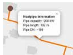
Fig. 5.9. Esempio di un popup interattivo per visualizzare le informazioni di un tubo di teleriscaldamento.
