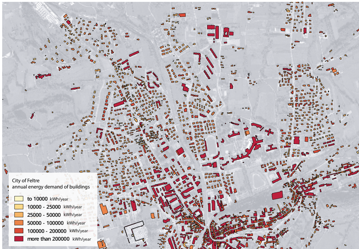
Fig. 3.10. Fabbisogno energetico degli edifici nella Città di Feltre. Abb. 3.10. Energiebedarf von Gebäuden in der Stadt Feltre.
